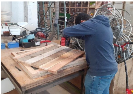
Atelier de fabrication de composteurs en bois de palettes récupérées
