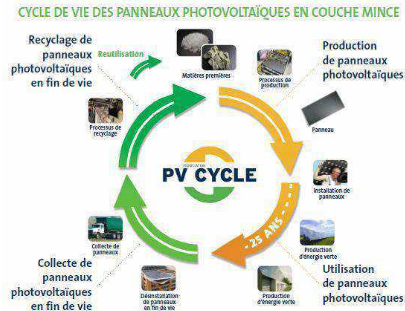
Figure 23 : Le cycle de vie des panneaux photovoltaïques en couche mince
