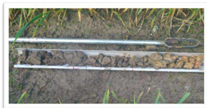
Photo 13 : Exemple de carottage sur une profondeur de 120 cm
